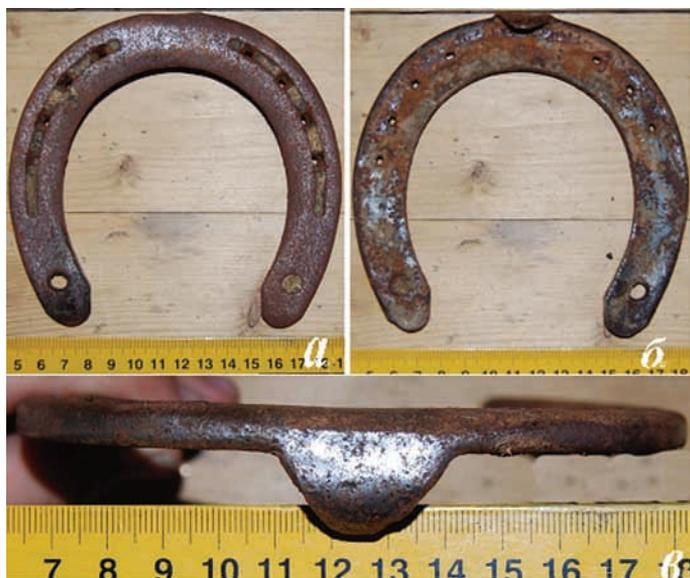
Рис.3. Подкова, бывшая в эксплуатации: а – вид с грунтовой поверхности, б – вид с копытной поверхности, в - передняя часть подковы
